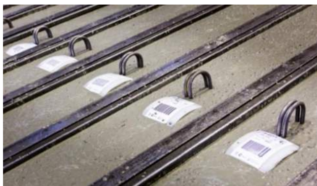
Figur 2-1 Den enkelte pæl er forsynet med stregkode for at sikre sporbarhed
