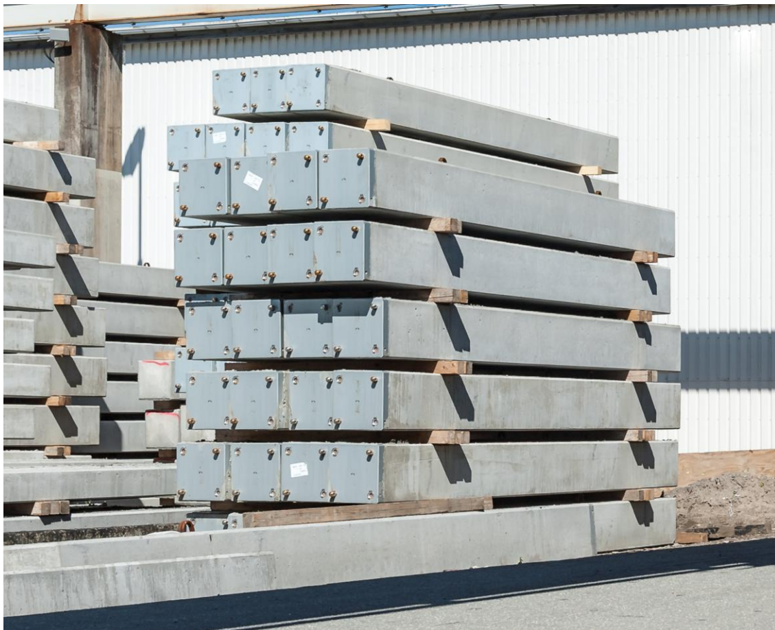
Figur 3-2 Oplagring af koblingspæle
