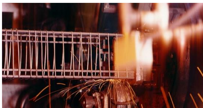
Figur 3-1 Svejserobot i funktion
