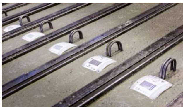
Figur 2-1 Den enkelte pæl er forsynet med strejkode for at sikre sporbarhed
