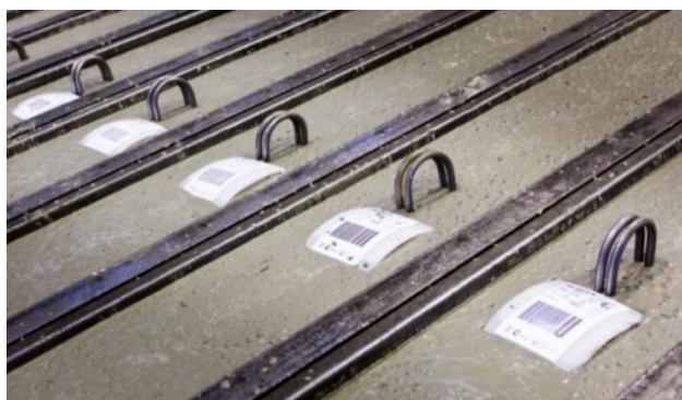
Figur 2-1 Den enkelte pæl er forsynet med strekcode for at sikre sporbarhed
