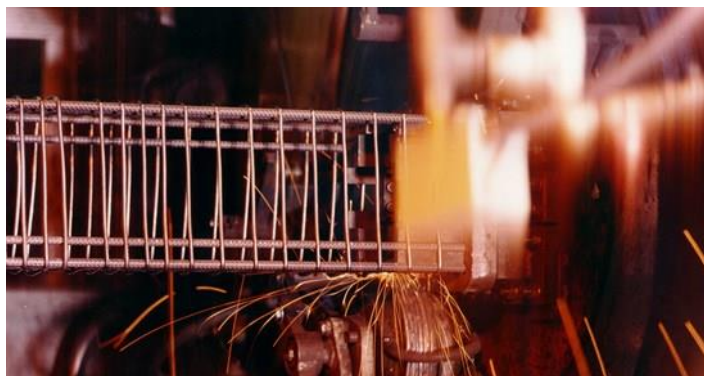
Figur 3-1 Svejserobot i funktion
